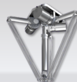
Высокоточный HDP+ особенно подходит для применения в механизмах роботов Delta
