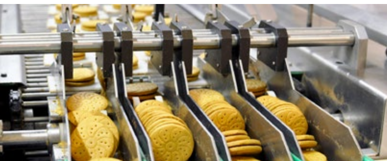
Süßwaren – Verpackungsanlage für Kekse
