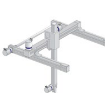
Pórtico de manipulación premo® SP Line
