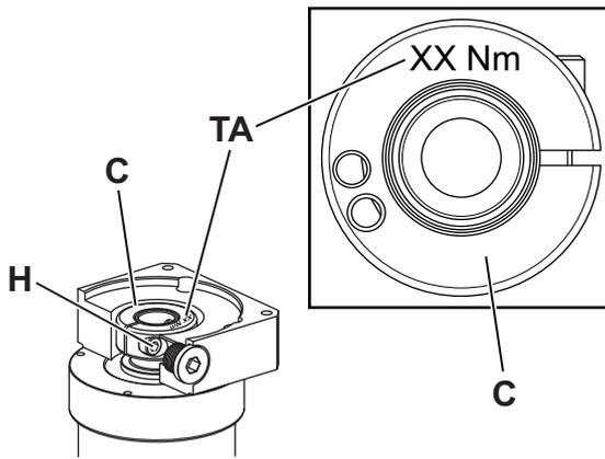
締め付けボルト [H] の締め付けトルク [TA] の値はクランプハブ [C] に記載されています。
