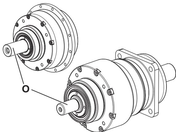
① 入力軸 [0] が付いている「入力軸付き仕様」の減速機バージョンに限っては、モータを装着することは想定されていません。この入力軸により、たとえばベルトプーリ等を介して減速機を直接駆動することができます。
