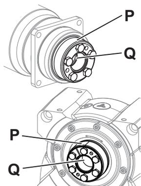
取り付け軸 / 中空軸 / 中空軸インターフェース [Q] をシュリンクディスク接続を使って荷重軸に軸方向に固定します。減速機をシュリンクディスク [P] 付きで注文した場合、シュリンクディスクは既に取り付けられた状態で納入されます。
