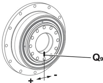
減速機の確実な潤滑とシール作用を保証するために、ドライブ側の最小旋回角度を遵守してください。
