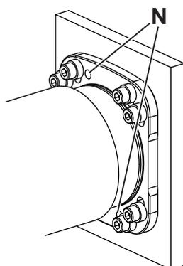
オプションとして、減速機ハウジングには減速機を機械に固定するための穴 [N] があります。減速機を平行ピンで機械に固定することもできます。
