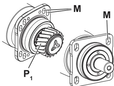
オプションで、減速機には出力ピニオン [P<sub>1</sub>] が装備されている場合があります。出力ピニオンとラック / 相手歯車の間のバックラッシュは長穴 [M] と側面のガイドで調整できます。追加の調整機構は不要になります。
