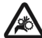
Peligro de arrastre
