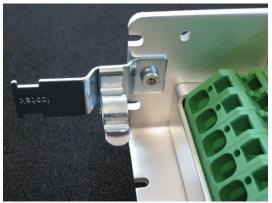
Al fine di rispettare i valori limite EMC e garantire il funzionamento dell'amplificatore di trasmissione, la schermatura del cavo motore deve essere collegata a bassa impedenza e su una superficie estesa all'alloggiamento dell'amplificatore di trasmissione.
