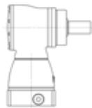
Position de montage B5/V3 (arbre de sortie horizontal, arbre moteur vers le haut)
