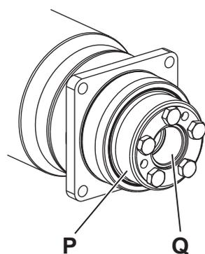
La fixation axiale de l'alésage non débouchant / arbre creux / interface d'arbre creux [Q] sur l'arbre de charge est réalisée à l'aide d'une frette de serrage. Si vous avez commandé un réducteur avec une frette de serrage [P], elle est déjà mise en place à la livraison.
