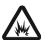
Pericolo di esplosione
