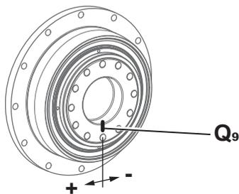
Para garantizar una lubricación y un efecto de sellado del reductor seguros, respete el ángulo mínimo de giro en la salida.
