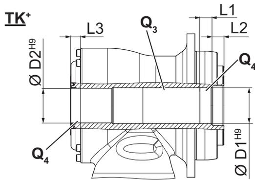
En el eje hueco / interfaz de eje hueco, las piezas vulnerables [Q<sub>3</sub>] deben protegerse contra medios agresivos.
