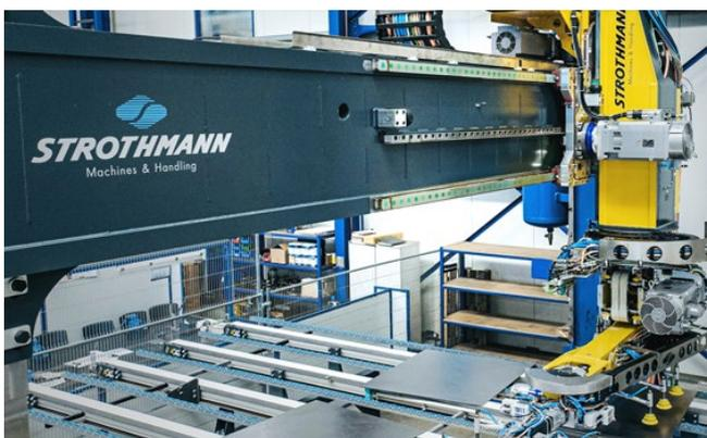
Strothmann Machines & Handling の最新プレスリンクシステムが、新たな標準を確立します。FeederPlus 6neo は、1 分間に最大 16 個の車体用成形ブランク (1 個の重量は最大 60kg) を、プレス間できわめて動的に、しかもミリメートル単位の精度で搬送します。この卓越した性能を実現しているのが、WITTENSTEIN alpha製の減速機、サーボアクチュエータ、ラック&ピニオンシステムです。その優れた出力密度によって、非常にコンパクトな設計にもかかわらず、高い駆動力と軸受力に対応することができます。
