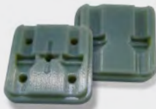
Frisch aus dem 3D-Drucker: Spritzgusswerkzeuge aus Kunststoff
