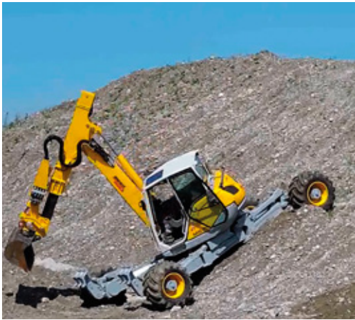
Der Bagger lässt sich aus sicherer Entfernung gefahrlos bedienen.
