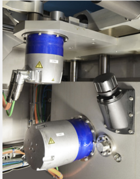
Einbausituation des TPM+ im Backenschließer (oben) und im Backenhub (unten)
