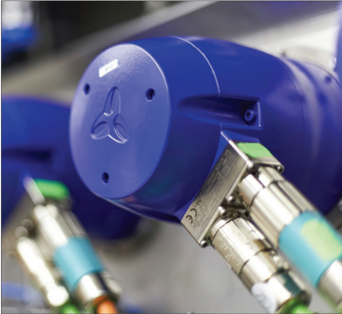
Die Servoaktoren haben einen Edelstahltrieb und eine spezielle Drei-Komponenten-Lackierung.
