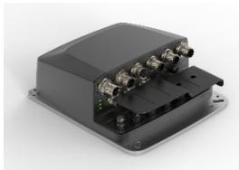
2. cyber® simco® drive 2 (SIM2100): Die perfekte Lösung für mobile Anwendungen (AGV) mit Schutzart IP65
